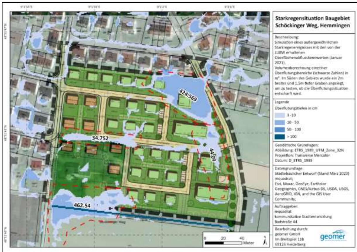
Abb. 3: Simulation mit Integration der geplanten Häuser und einem 2 m breiten und 1,5 m tiefen Graben im Süden des Baugebiets. Darstellung der Volumina der überfluteten Flächen in m<sup>3</sup>.
