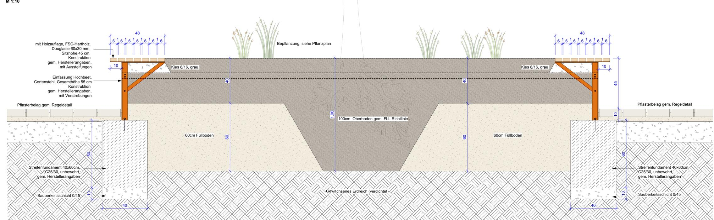
Regeldetail **Grabfeld A:** Einfassung erhöhte Pflanzbeete mit Urnenrohren
