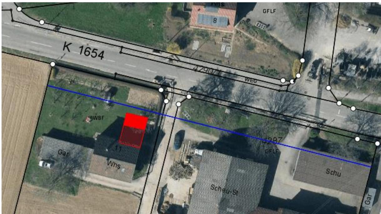
Die geplante Garage hat eine Grundfläche von 21 m<sup>2</sup>, die vorgesehene Überdachung überspannt eine Fläche von 30 m<sup>2</sup>. Während die Flachdachgarage eine Höhe von 2,60 m aufweisen wird, steigt die Überdachung über 5 m mit einer Neigung von 10° auf der Seite des Wohngebäudes auf eine Höhe von 3,73 m an. Die Zuwegung wird mit versickerungsfähigem Pflastersteinbelag ausgeführt.
