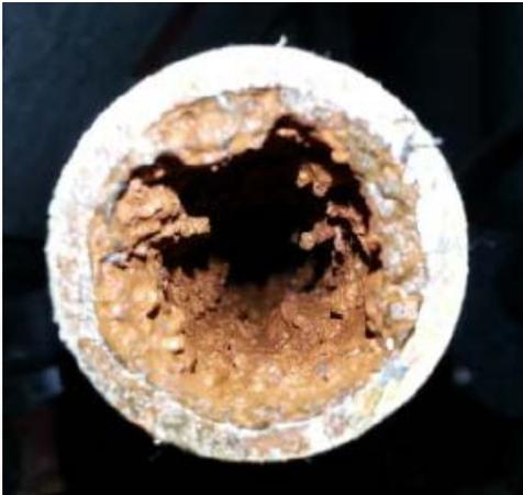
➔ **Aufgrund der erhobenen Daten und festgestellten Mängel wie zum Beispiel die massive braune Färbung des Trinkwassers an unterschiedlichen Trinkwasserentnahmestellen ist eine komplette Sanierung des gesamten Trinkwasserinstallationssystems unvermeidlich.**
